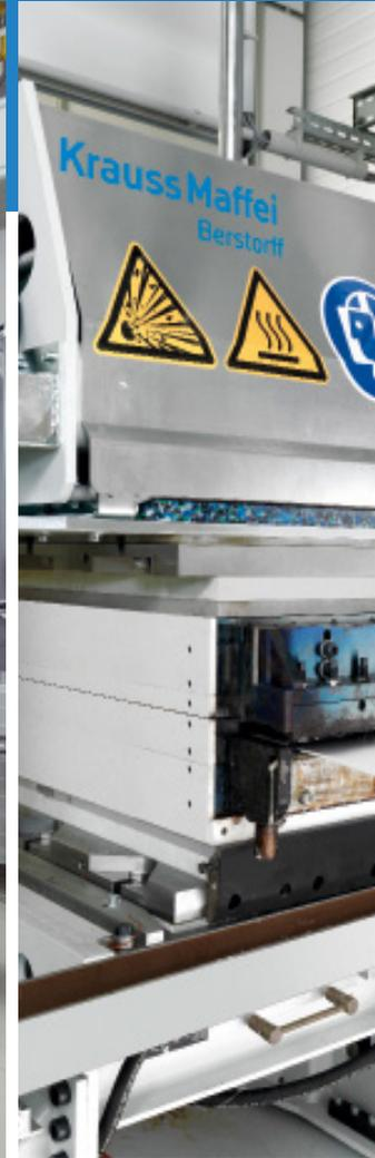
*Mit der UD-Tape-Anlage können auch biobasierte Kunststoffe verarbeitet werden – mit bis zu 20 Metern pro Minute.*
