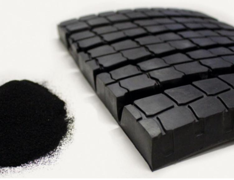
*Auf der Nanoskala optimierte Komposite tragen dazu bei, den Rollwiderstand von Reifen zu senken.*
